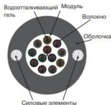
Рисунок 2.6 – Строение оптического кабеля
